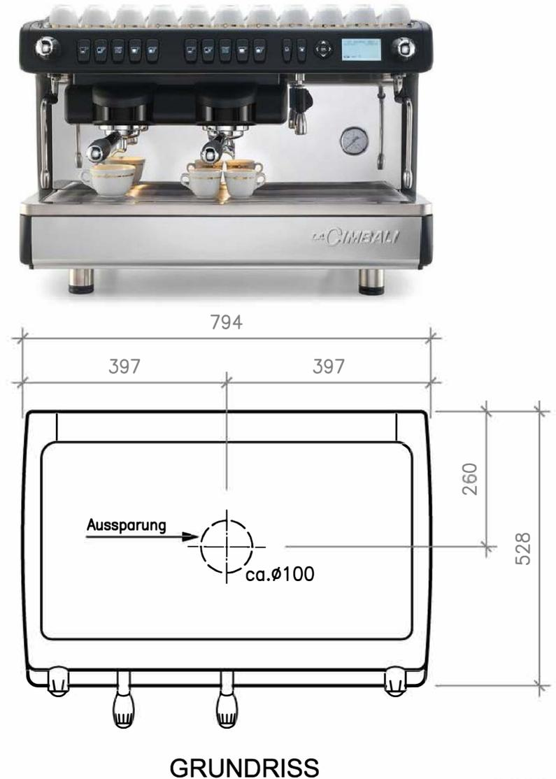
ANSCHLUSSSCHEMA FÜR KAFFEEMASCHINE MODELL M-26 DT /1
