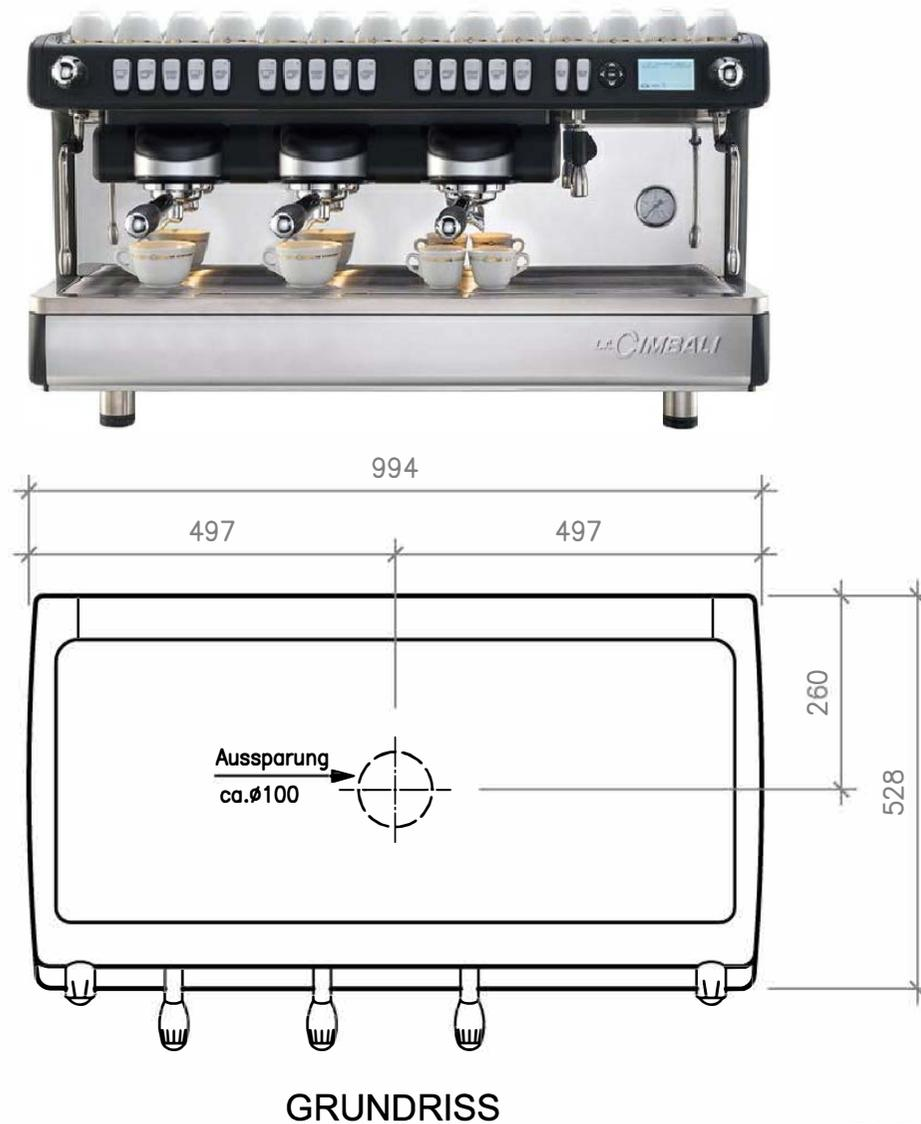
ANSCHLUSSSCHEMA FÜR KAFFEEMASCHINE MODELL M-26 DT /2
