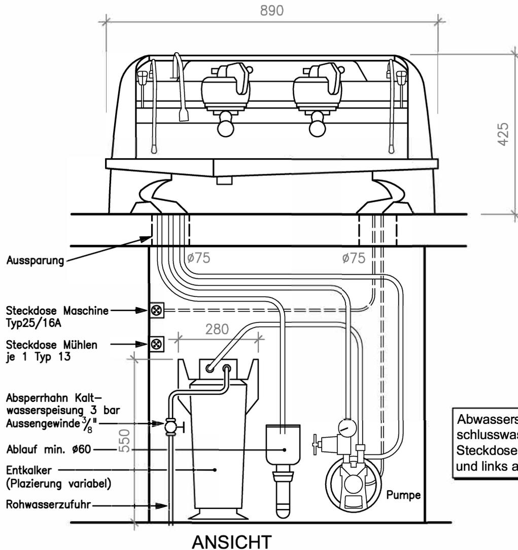
Abwassersyphon und Anschlusswasserhahn sowie Steckdose(n) möglichst hinten und links am Rand montieren
