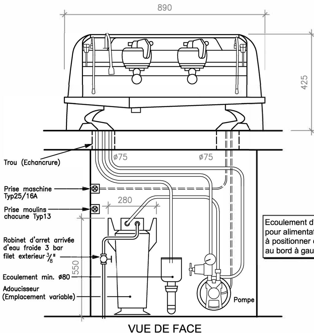
Écoulement d'eau usée et robinet pour alimentation ainsi que prise(s) à positionner derrière la machine au bord à gauche
