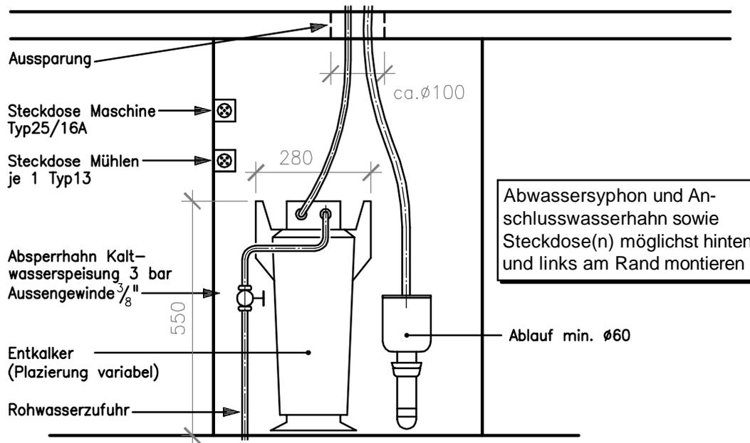
Abwassersyphon und Anschlusswasserhahn sowie Steckdose(n) möglichst hinten und links am Rand montieren
