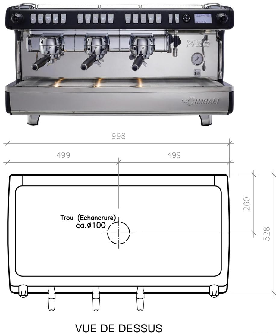
Écoulement d'eau usée et robinet pour alimentation ainsi que prise(s) à positionner derrière la machine au bord à gauche
