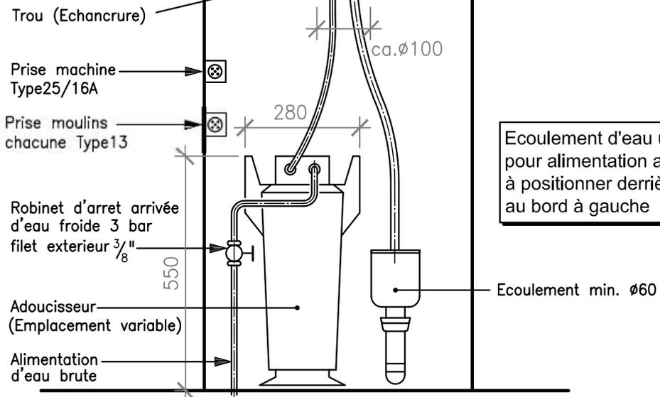
Écoulement d'eau usée et robinet pour alimentation ainsi que prise(s) à positionner derrière la machine au bord à gauche
