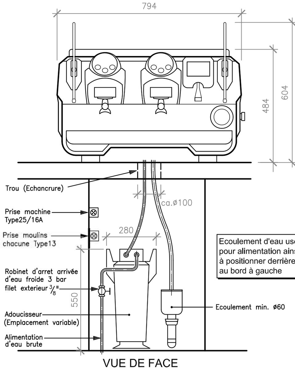
Ecoulement d'eau usée et robinet pour alimentation ainsi que prise(s) à positionner derrière la machine au bord à gauche
