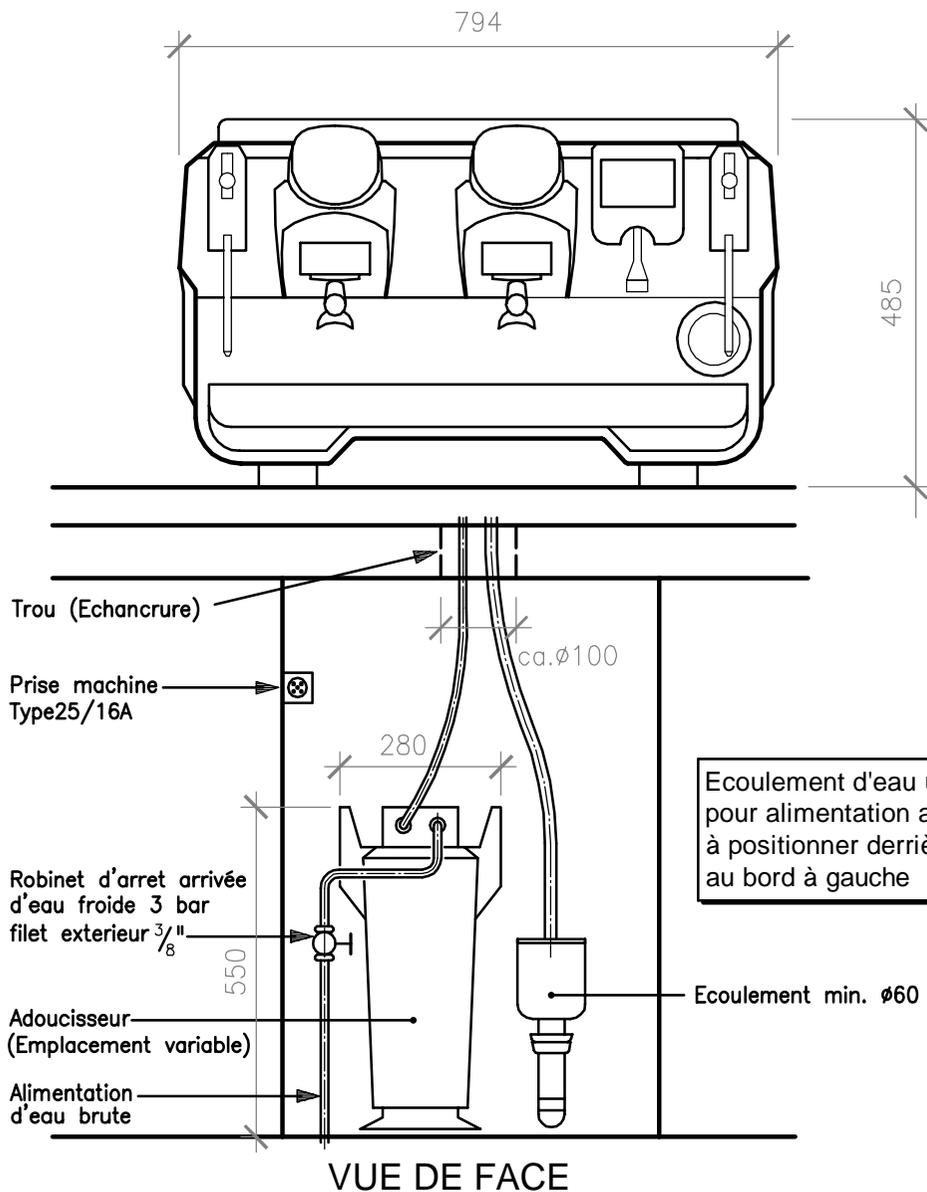
Ecoulement d'eau usée et robinet pour alimentation ainsi que prise(s) à positionner derrière la machine au bord à gauche
