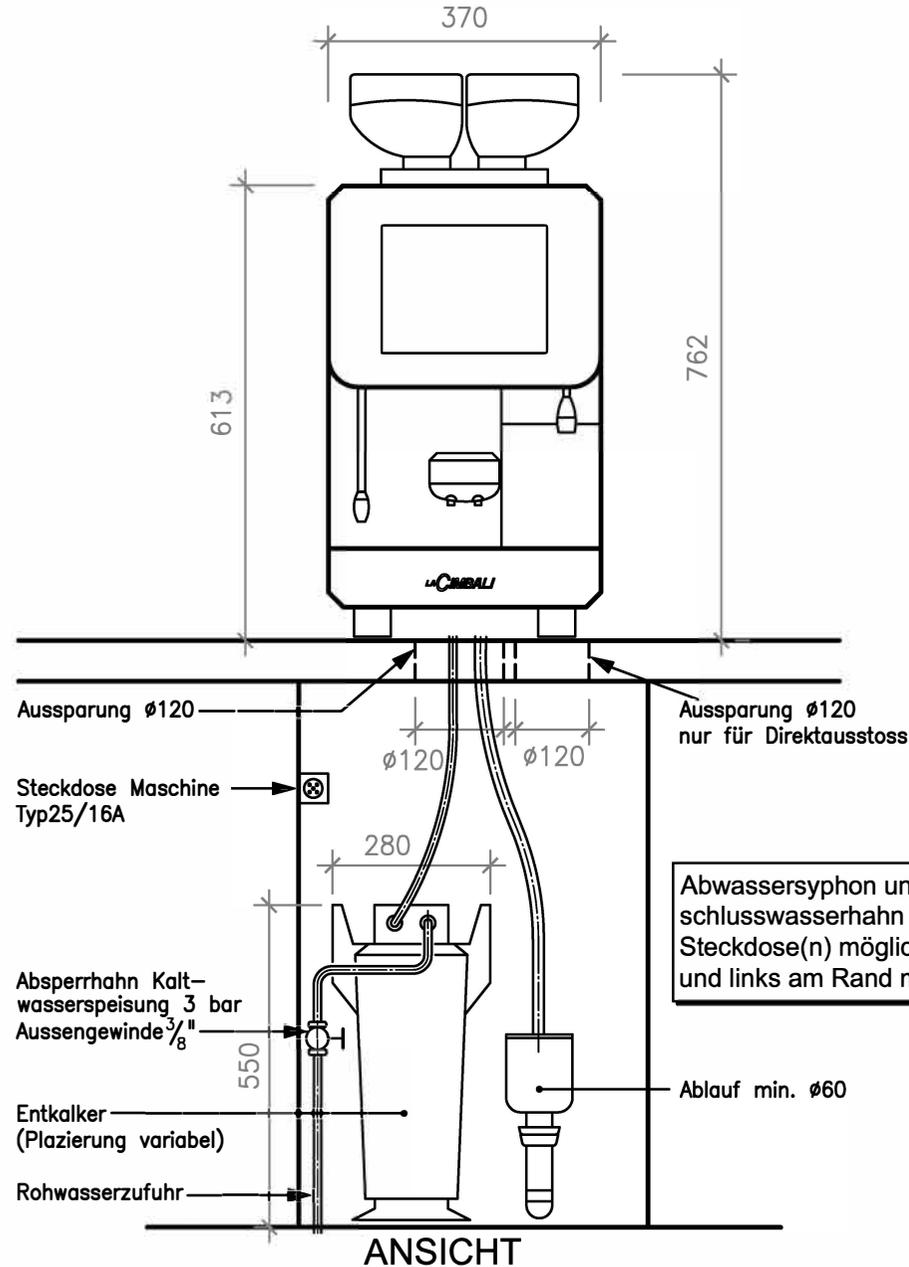
Abwassersyphon und Anschlusswasserhahn sowie Steckdose(n) möglichst hinten und links am Rand montieren
