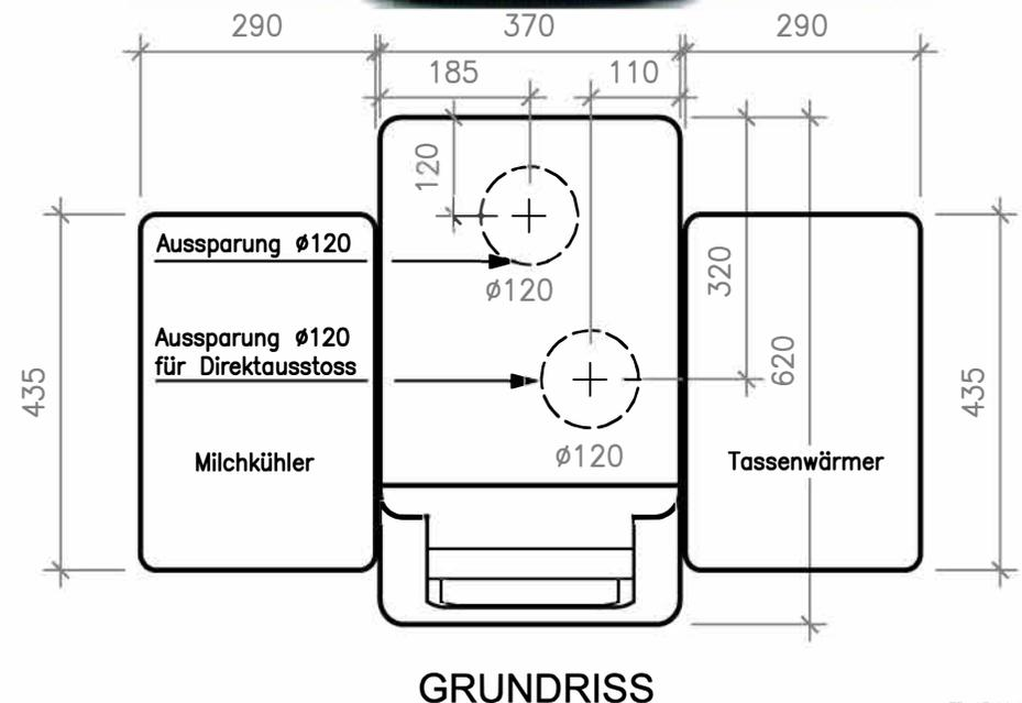
ANSCHLUSSSCHEMA FÜR KAFFEEMASCHINE MODELL S-20 MIT MILCHKÜHLER
