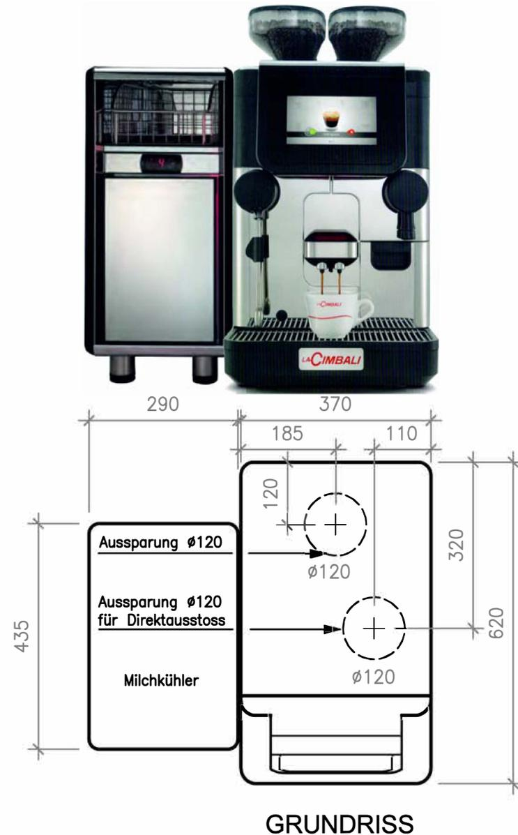
ANSCHLUSSSCHEMA FÜR KAFFEEMASCHINE MODELL S-20 MIT TASSENWÄRMER
